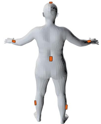
Das neue Verfahren zur Rekonstruktion der Körperhaltung kommt mit sechs Inertialsensoren aus, die an Hand- und Fußgelenken sowie an Kopf und Rücken befestigt sind.
