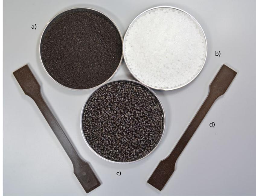
Aus Kaffeesatz (a) und einem Matrixpolymer (b) entsteht ein biobasierter Verbundwerkstoff (c), der zunächst im Labor mittels Prüfkörper (d) getestet und optimiert wird. Aus dem Material könnten Serviertabletts und Bürozubehör entstehen.
