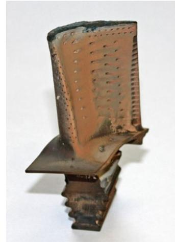
Komplexe Bauteile wie diese verschlissene Turbinenschaufel sollen künftig besser repariert werden können, statt sie durch teure Neuteile zu ersetzen.
