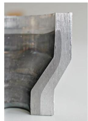
Massivbauteile aus verschiedenen Materialien, hier eine hybride Lagerbuchse aus Aluminium und Stahl, ermöglichen verschleißfeste Konstruktionen im Sinn des Leichtbaus.
