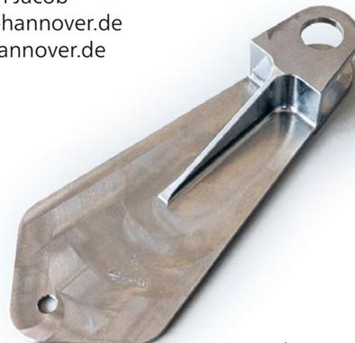
Durch neue Kühlkonzepte und Reinigungsprozesse lassen sich hochwertige Bauteile aus Titanspänen fertigen.
