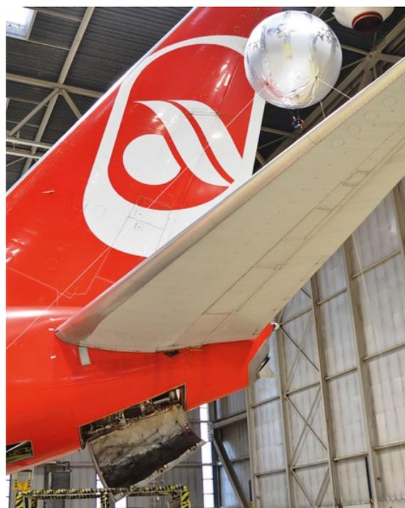
Die Infrarotkamera am handgeführten Gasballon sucht Bauteilschäden am Seitenruder.
