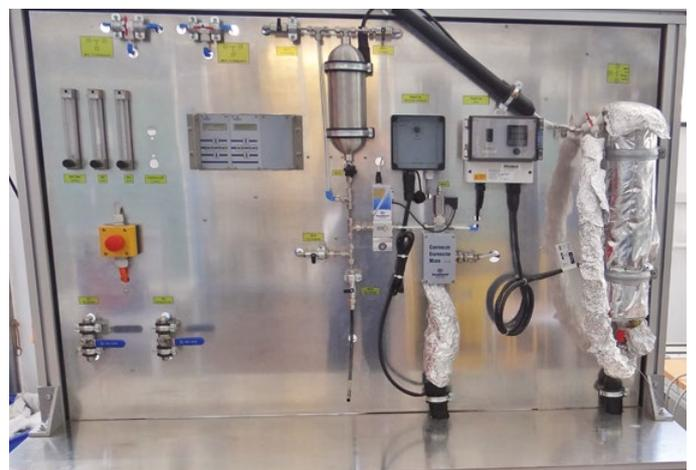
Die Anlage ermöglicht es, die Effizienz von Kalkprodukten bei der Reinigung von Rauchgas zu ermitteln.
