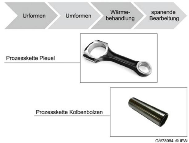
Prozesskette für gewichtsreduzierte Pleuel und Kolbenbolzen aus aluminiumlegiertem Leichtbaustahl
