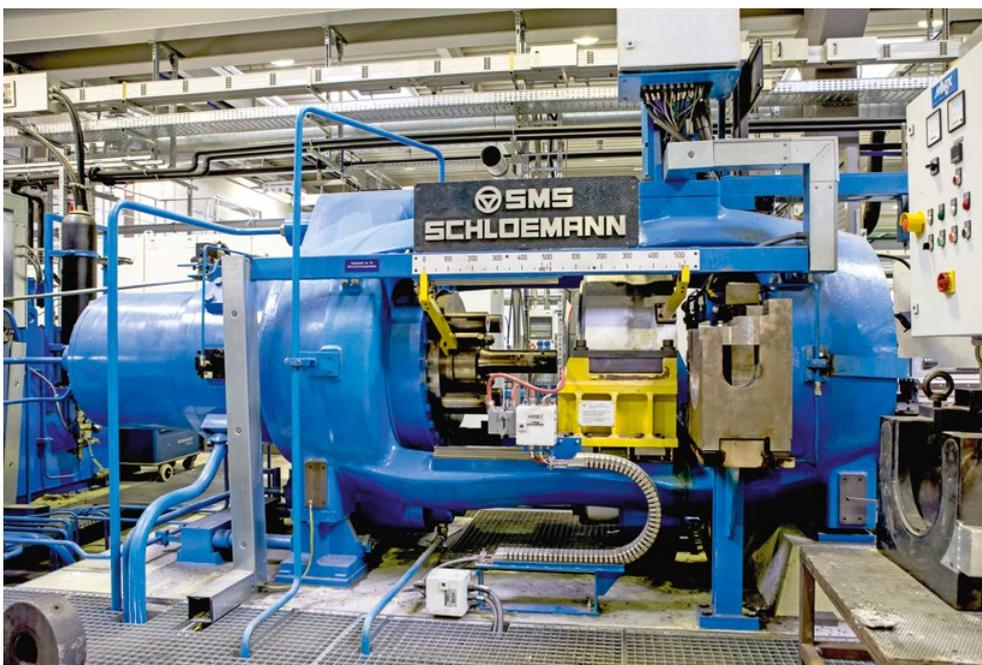
Mit neuartigen Verfahren können an der Strangpresse hybride Werkstücke aus Aluminium und Stahl gefertigt werden.
