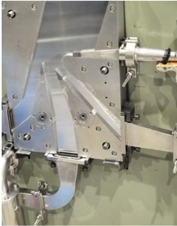
Das Bild zeigt die offene Sichtkammer des Matsubo EJ-L3. Das Gerät ermöglicht die Fraktionierung des Zements in drei Klassen in einem Schritt.
