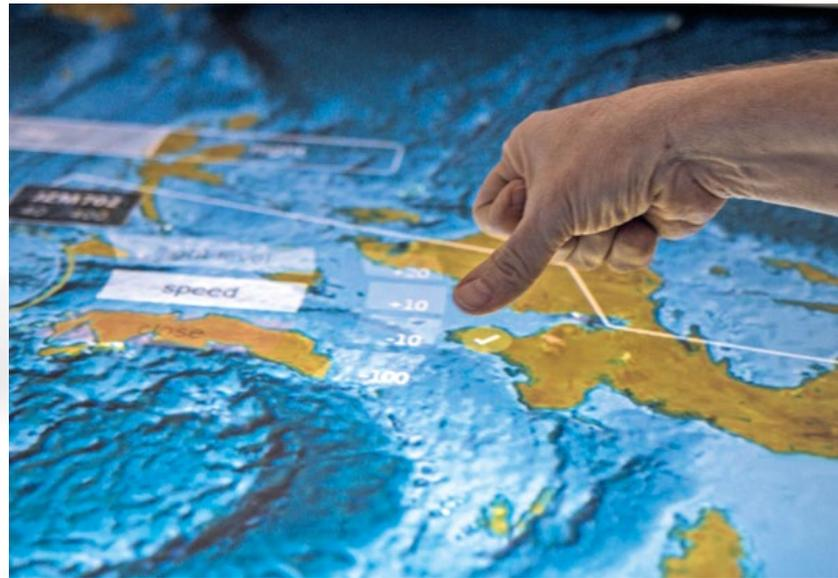
Der Multitouch-Bildschirm ermöglicht es den Fluglotsen, intuitiv per Finger zu steuern, einzelne Ansichten zu wählen und zu verschieben.
