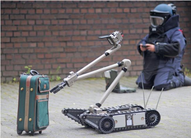
Enthält der Koffer eine Bombe? Roboter helfen bei der Aufklärung und schützen damit die Einsatzkräfte.
