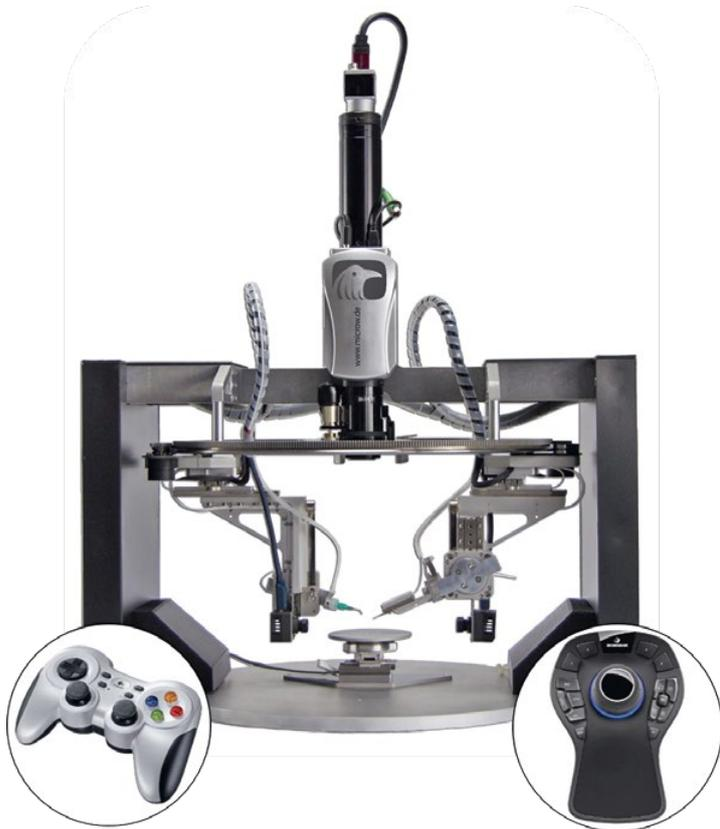
Die Mikromontageanlage passt auf jeden Arbeitstisch. Der Anwender hat leichten Zugang zum Probenraum und eine gute Übersicht. Er kann die Werkzeuge per Gamepad (links) oder 6D-Maus (rechts) ansteuern.
