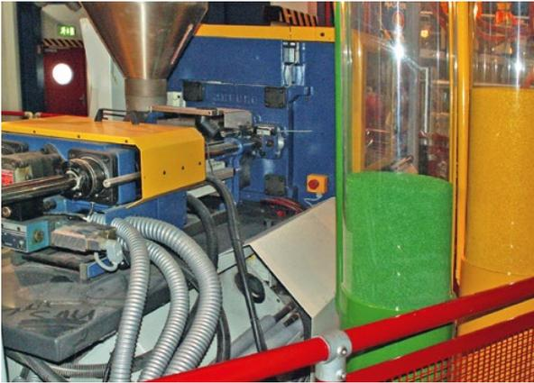
Thermoplast-Spritzgießmaschinen, die zum Beispiel Legosteine fertigen, liefern riesige Datenmengen pro Sekunde. Für eine effiziente Prozesssteuerung müssen diese Daten sinnvoll gefiltert und verarbeitet werden.
