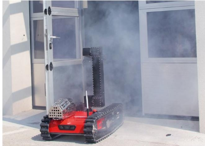
Die Sicht ist schlecht und die Gefahrenlage unklar: Der Roboter scannt die Umgebung, misst Temperatur und Gas.
