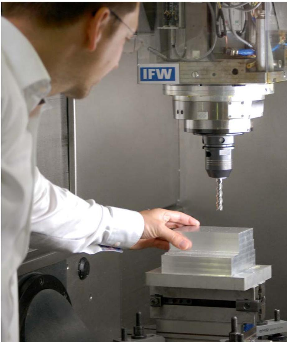
Das Fräszentrum der „fühlenden Maschine“: Forscher der Leibniz Universität haben einen speziellen Z-Achs-Spindelschlitten (oben) gebaut und mit Sensoren ausgestattet. Diese messen die auftretenden Dehnungen während des Bohrens und FräSENS und dienen der präzisen Prozesssteuerung.
