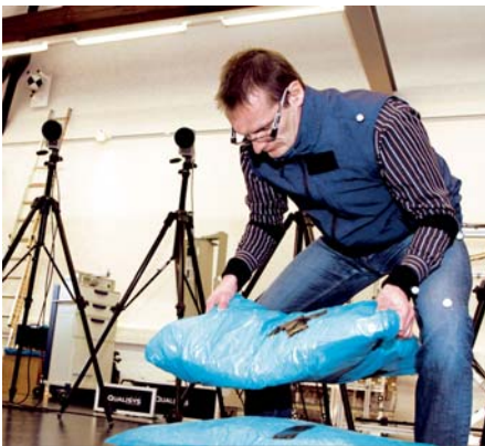
Häufiges Bücken schadet dem Rücken: Kameras erfassen die ungünstigen Bewegungen dreidimensional, eine neue Software wertet die Aufnahmen automatisiert aus.
