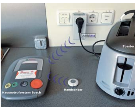
Der patentierte Zwischenstecker AmbiAct erleichtert die Nutzung eines Hausnotrufsystems. Wird der Toaster – oder ein anderes Elektrogerät – angestellt, wird automatisch das Signal gesendet: „Mir geht es gut.“
