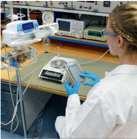
Handheld und Schaltbox – hier als Prototypen zu sehen – unterstützen medizinisches Personal dabei, Infusionspumpen vor ihrem Einsatz zuverlässig zu prüfen.
