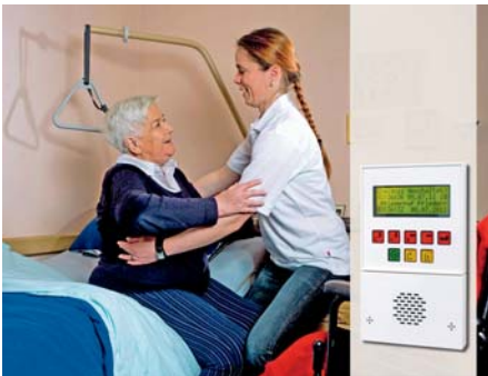
Wenn kein Pflegepersonal in der Nähe ist, kann die Notrufanlage SonicSentinel akustische Ereignisse differenziert erkennen und bei Gefahr automatisch einen Notruf auslösen. Bilder: Fraunhofer IDMT und Johanniter/Paul Hahn
