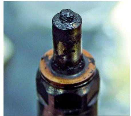
Verkokung einer Einspritzdüse bei Verwendung von reinem Rapsöl – mit Kraftstoffmischungen können solche Nachteile von Biokraftstoffen minimiert werden.
