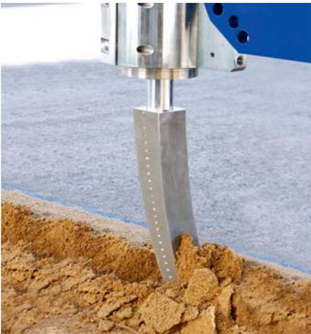
Grubberzinken mit Ultraschallanregung: Der Ultraschall versetzt den Zinken in hochfrequente Schwingung, dadurch gleitet er leichter durch den Boden.
