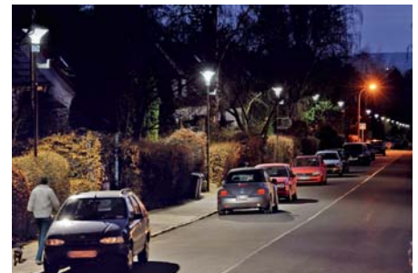
LED-Straßenleuchten wie hier in Göttingen spenden angenehmes Licht, sparen viel Energie und können intelligent gesteuert werden: Ist kein Fußgänger unterwegs, wird die Lichtleistung gedimmt. Bild: Philips GmbH, 2011
