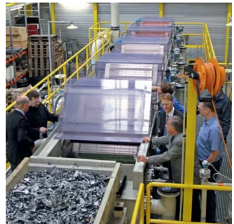
Pilotanlage zur Zinkgewinnung aus Stahlschrott im Technikum der CUTEC-Institut GmbH
